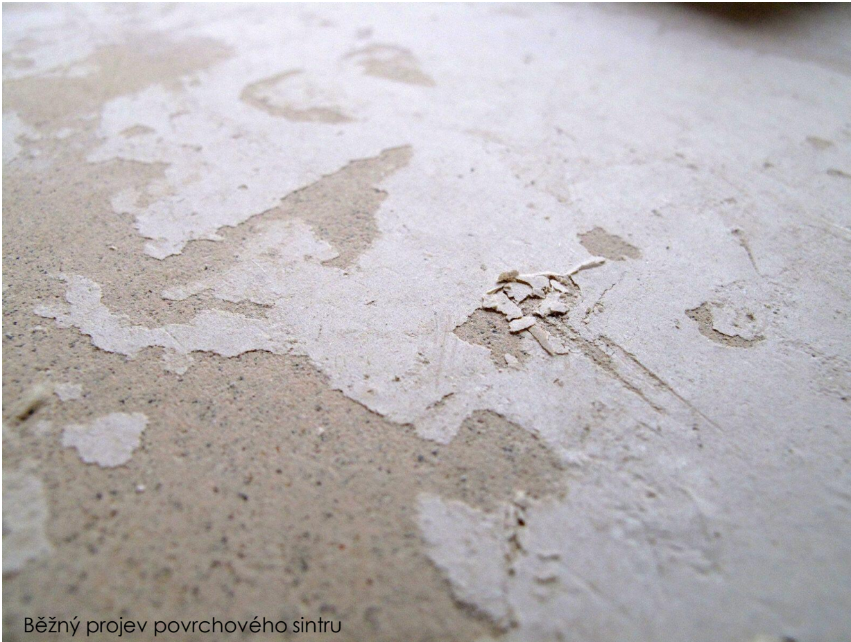
Nadměrná vrstva sintru v důsledku zpracování
