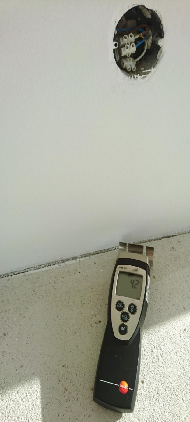
Vliv vlhkosti okolních konstrukcí na podlahu
