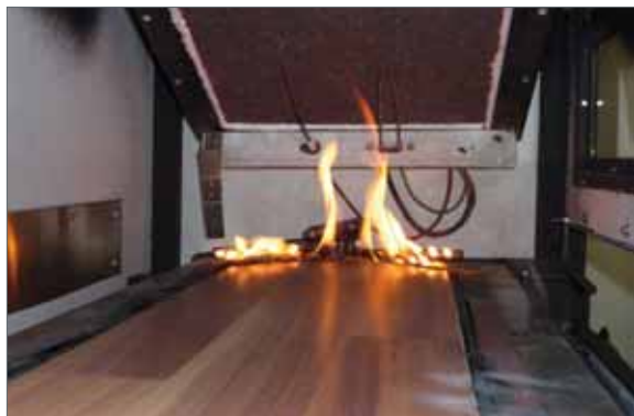
Zkouška hořlavosti laminátové podlahy na tzv. sálavém panelu.
